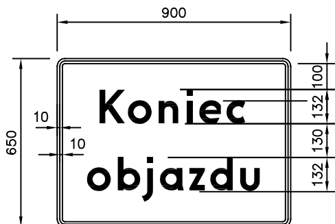
konstrukcja tablicy F-9f
